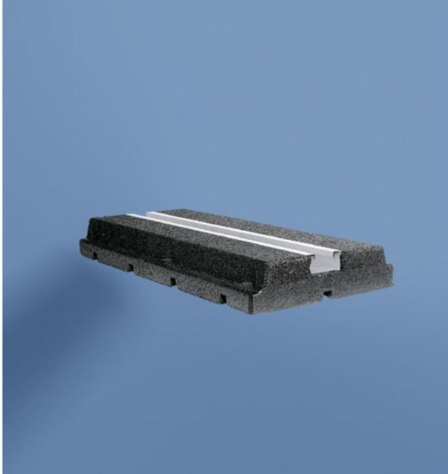
MINI base a pavimento realizzata in gomma riciclata SBR dotata di profilo in alluminio annegato sulla base durante lo stampaggio. Assorbimento ottimale delle vibrazioni e dei rumori grazie alla mescola utilizzata, che ne garantisce la stabilità e la lunga durata nel tempo. Provvisto di predisposizione per il fissaggio a terra e fondo scavato per il drenaggio dell'acqua.
